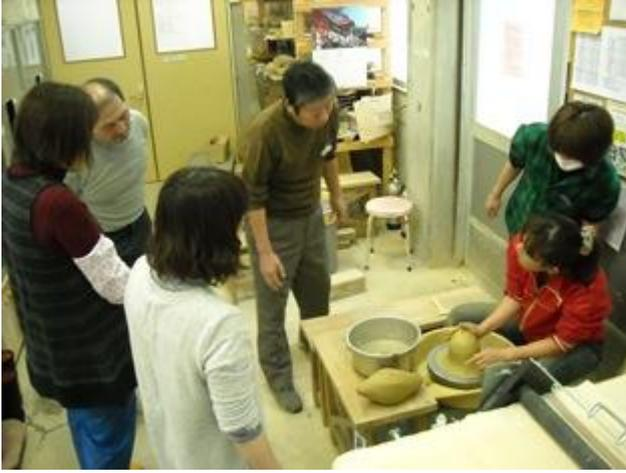
練った土をろくろの盤の真ん中にくっつけたら、しっかりとお水をつけて滑るようにし、両手で粘土を挟む様に力を加え上に伸ばしていきます。そして長く伸びたら、今度は粘土を縮めて最初の状態に戻します。
